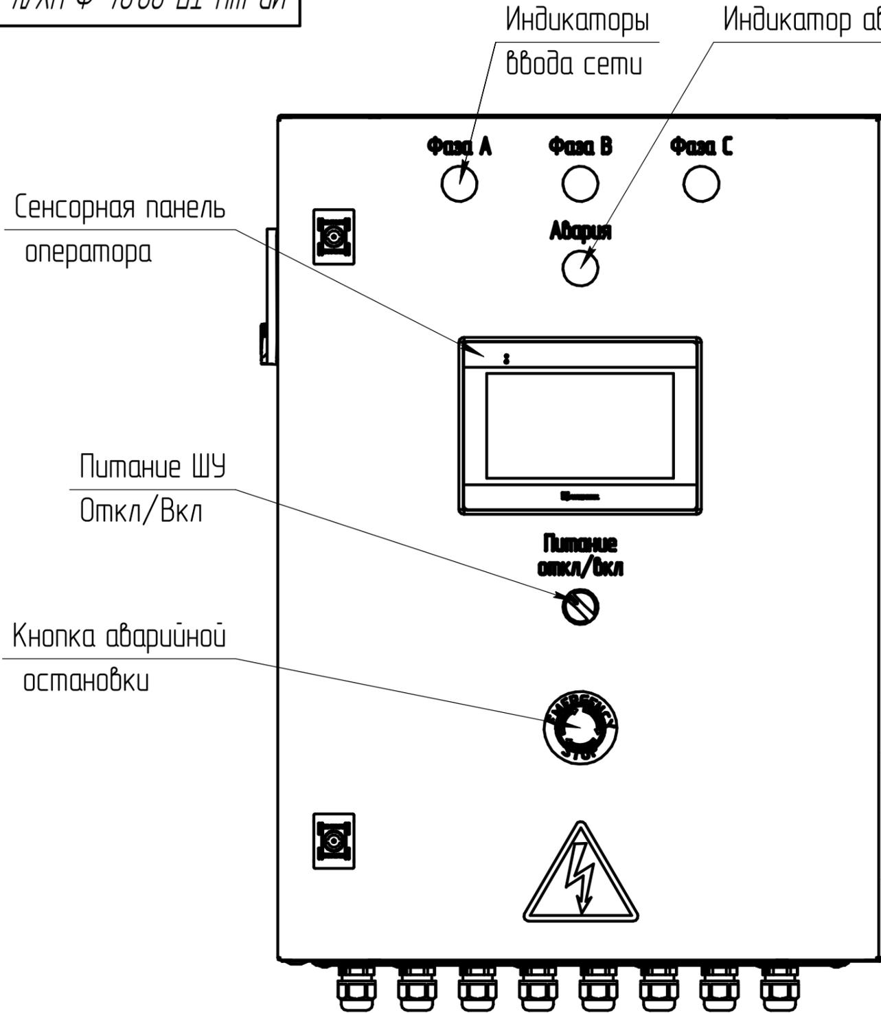
Индикаторы ввода сети    Индикатор аварии    Реле контроля напряжения    Блок Питания    Контроллер ПР200    Сигнализатор уровня
